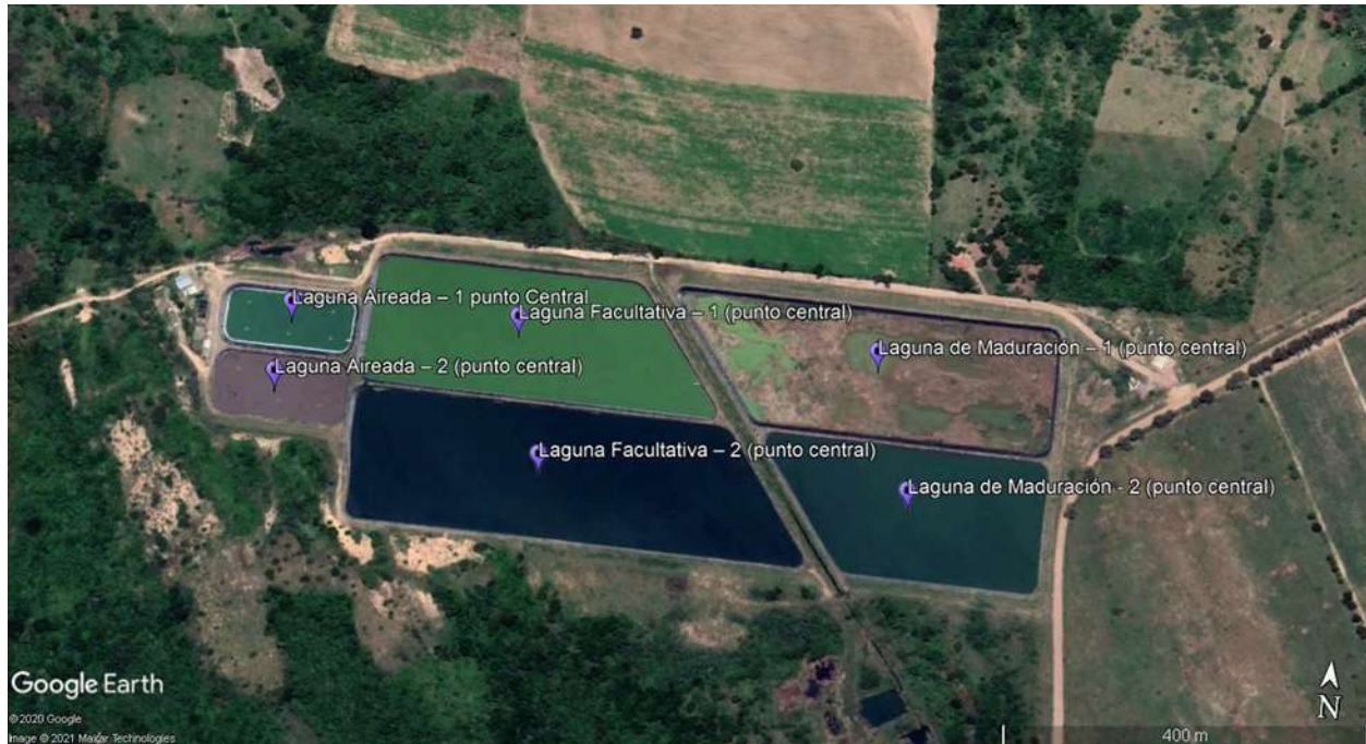
Figura 4. Tratamiento secundario en la PTAR COOPLAN
