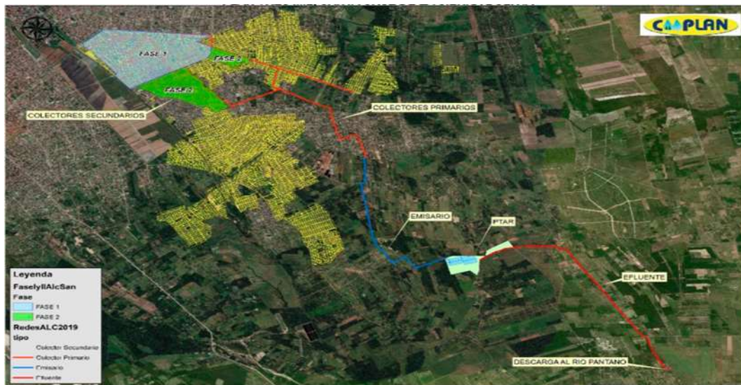
Figura 2. Sistema de alcantarillado existente Fase I y Fase II y PTAR COOPLAN
