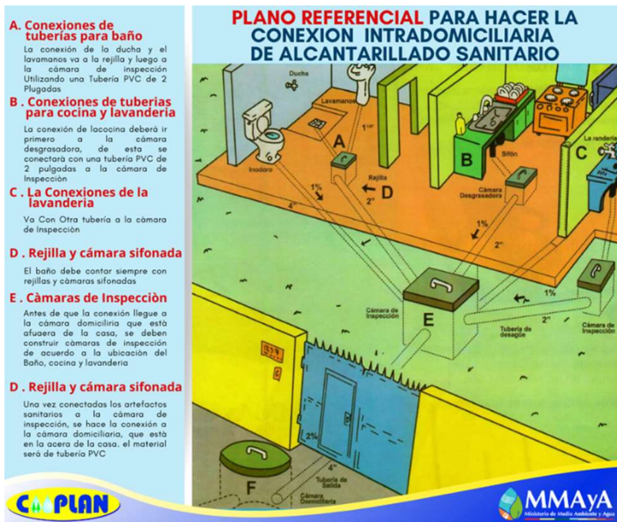
Figura 21. Esquema de conexión intradomiciliaria
